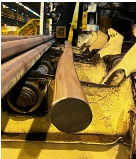
شکل (۴): شمش خیلی ناصاف با خمیدگی و تاب‌خوردگی مشخص در طول شمش
